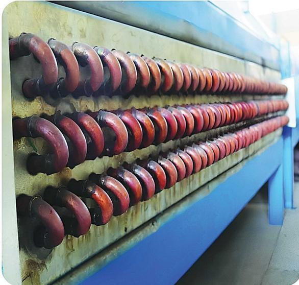
فین های مود استفاده در دستگاه از نوع آلومینیوم، مس و برنج به ضخامت های مختلف از ۰٫۵ تا ۱ میلیمتر تا ۱ میلیمتر و گام های ۴۵-۴۰ و ۵۰ میلیمتر و به ردیف های ۲، ۴، ۶ و ۸ قابل ساخت می باشد.
